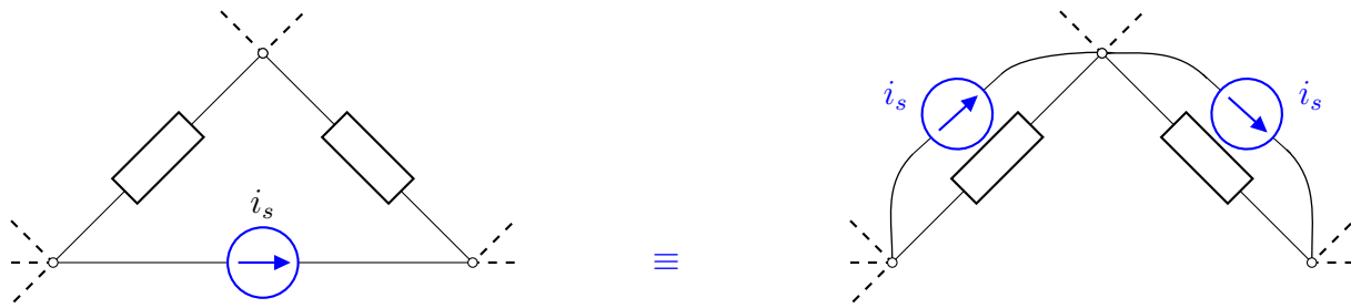
Figura 3.2: Transformación de una fente ideal de corriente en una fente real de corriente.
