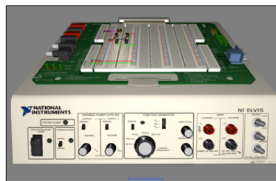
Módulo y Tarjeta Prototipo NI ELVIS y software instalado NI ELVIS 2.0 que incluye: Fuente de voltaje, Generador de funciones, Osciloscopio, Tableta de conexiones.
